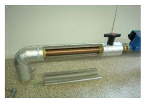
Das Rohrstück wird separat gehalten, um es in der Länge anpassen zu können.
