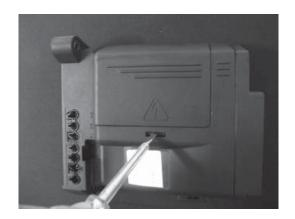
2. Die beiden Stecker auf die Steckplätze 20 (Fernentriegelung) und 21 (Störlampe) stecken
