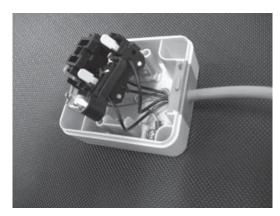
5. Funktion: Bei einer Brennerstörung leuchtet die LED im Taster rot auf. Durch kurzes Bestätigen des Tasters wird der Brenner entriegelt. Die Störlampe erlischt. Achtung, der Brenner kann auch durch Drücken des Tasters im Normalbetrieb manuell verriegelt werden! Der Anlagenbetreiber sollte in jedem Fall darauf hingewiesen werden.
