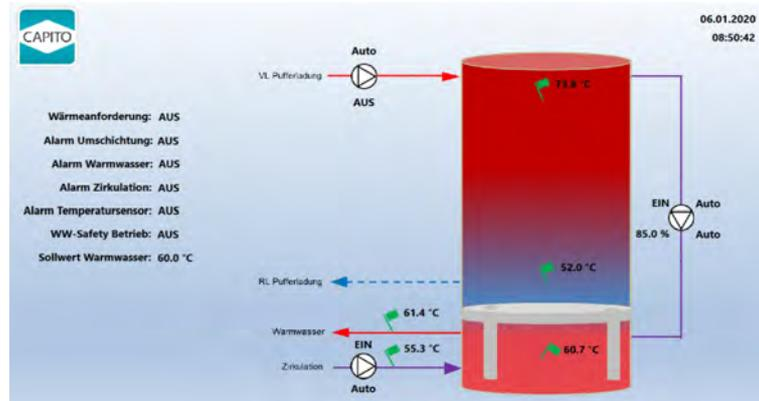
Easy Access ist eine Schnittstelle zur komfortablen Anlagenüberwachung, Fernbedienung, Datenlogging und Visualisierung der Regelung per CAN-Bus. Der Fernzugriff kann ohne komplizierte und zeitaufwendige Einrichtung eines Routers erfolgen.
