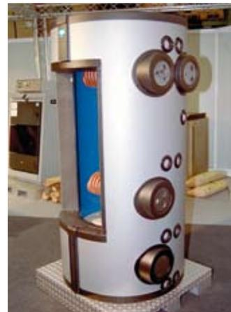
■ Die Besonderheit des Speichers „Solar-Schichtungs-PD“ liegt in der Unterteilung in zwei Pufferzonen: Im unteren Teil wird das Heizwasser über den Solarkreislauf erwärmt. Der obere Speicherbereich ist der Heizwasserpuffer zur Trinkwassererwärmung, dessen Inhalt zu 100 % durchwärmt werden kann.
